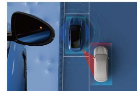
Door Open Warning (DOW)
